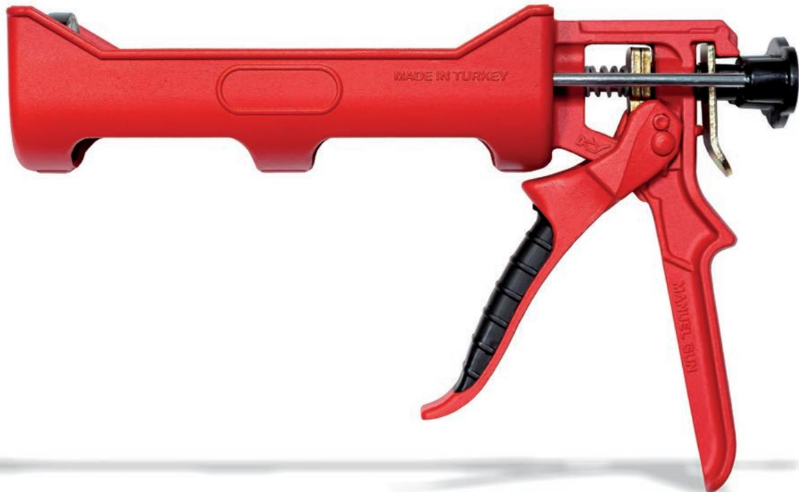
Questa pistola per silicone è stata progettata appositamente per un uso professionale intensivo in applicazioni bicomponenti come l'ancoraggio chimico. È dotata di un corpo in alluminio resistente e di una doppia barra in acciaio al carbonio zincato azionata da due piastre per un'estrusione potente.
